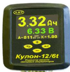
Сурет-6. Кулон-12/6t – қорғасын батареясының сыйымдылығын тексеру құралы/индикаторы
